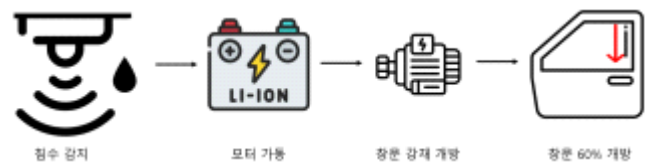
[그림4] 차량 침수 인명사고 예방을 위한 자동 창문 개방 장치 작동 방식
